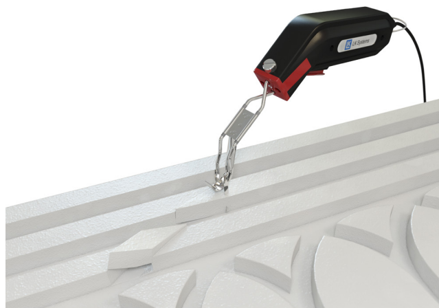
Spårning i EPS cellplastskiva med LK Värmekniv 90 W.
